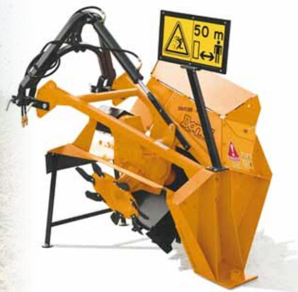
Les modèles mono/double roues curent les deux parois du fossé en éjectant d'un seul côté. Pour un travail de curage il est conseillé d'avoir une vitesse d'avancement de 1.2 à 1.4km/h tandis que pour la création d'un nouveau fossé votre tracteur doit être doté de vitesses rampantes pour avancer de 0.8 à 1.2km/h.
