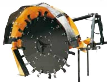
Dondidrenag est efficace dans les sols non-rocheux pour la création de tranchées et la pose de tuyaux de drainage, de câble électrique ou téléphonique. Pour passer de 8 à 14cm de largeur de tranchée, il suffit d'inverser le positionnement des lames. Pour obtenir 20cm un kit spécial est disponible en option. La terre peut être évacuée sur le côté ou a proximité de l'excavation pour faciliter la fermeture de la tranchée.
